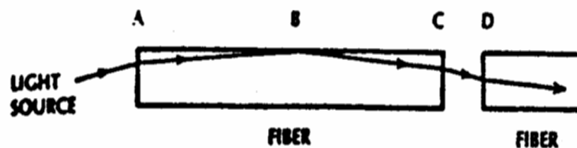
Gambar 3.5 Dispersi yang mengakibatkan penurunan amplitudo sinyal analog
