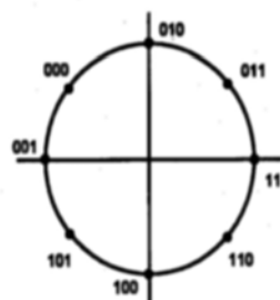
Gambar 2. Diagram konstelasi 8-PSK tanpa rotasi yang digunakan EDGE
